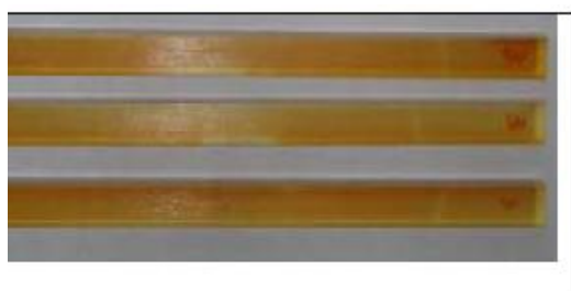
شکل ۴: نمونه های ساخته شده برای تست خمش [۲]
