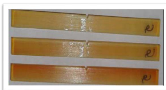
شکل ۶: نمونه ی ساخته شده برای تست ضربه [۲]
